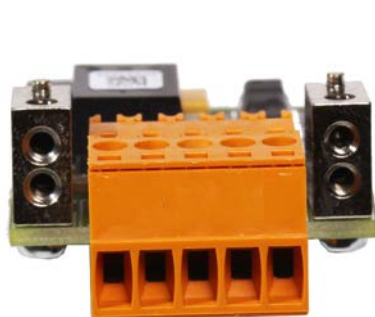
Abbildung 46: Frontseite bzw. LED-Anzeigen abgesetzte Netzwerkschnittstelle CC-Link (AIFX-CC)
